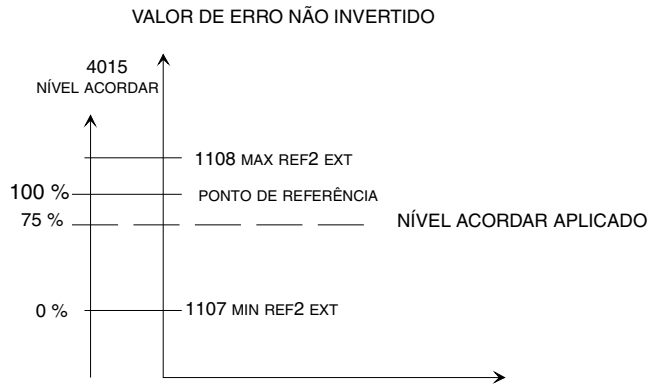
Figura 18 Exemplo de como o nível acordar aplicado flutua com o ponto de referência, aqui o parâmetro 4015 NÍVEL ACORDAR é igual a 75 %, caso não invertido de controle-PID.
