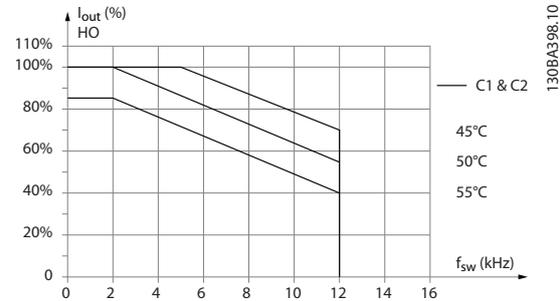
**Ilustração 6.20** Derating da I<sub>out</sub> para diferentes T<sub>AMB, MAX</sub> do gabinete metálico tipos C1 e C2, utilizando 60° AVM no modo alta sobrecarga (160% de sobretorque)
