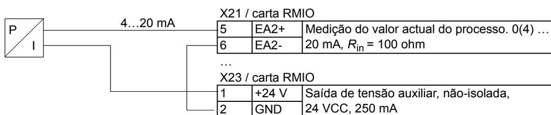
**Nota:** O sensor é alimentado através da sua saída de corrente. Por isso o sinal de saída deve ser 4...20 mA, e não 0...20 mA.
